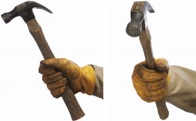
Figura 11. Agarre de un martillo: (a) Correcto; (b) incorrecto con la muñeca flexionada
